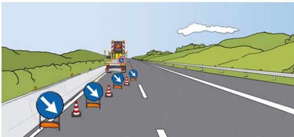
Figura 33 – Chiusura della corsia di sorpasso: installazione della testata di esclusione della corsia
