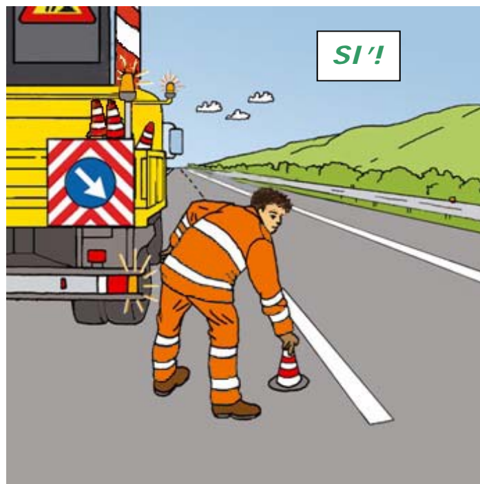
Figura 45 – Posizionamento dei coni o de.fle.co.: comportamento corretto
