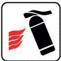
Indica presenza estintore
